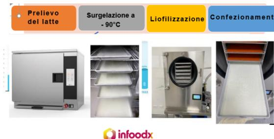
Figure 2: Processo di liofilizzazione del latte e attrezzature impiegate.
